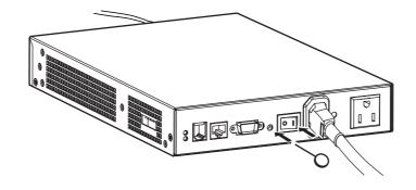
3. CHECK/LAN0~3/COM/B1/B2ランプが緑色で点滅するのを確認して、リセットスイッチをはな します。
