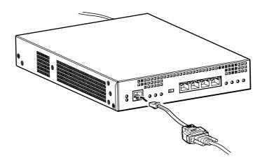
2. 先の細いものでリセットスイッチを押しながら電源を投入します。
