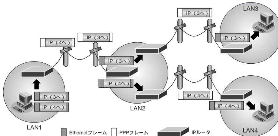
なお、本装置ではIP以外のパケットを転送する機能であるブリッジについてもサポートしています。IPアドレスを持たないIP以外のパケットは、Ethernetフレームの情報に従って適切な相手にデータを転送することができます。
