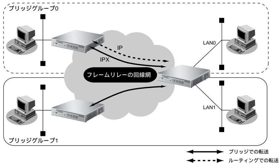
IP フレームをブリッジ対象とした場合、WAN インタフェース上ではブリッジで中継される Ethernet フレームだけが送受信され、直接 WAN 側に Ethernet フレームではない IP パケットを送受信することはできません。
