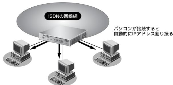
本装置はクライアントに IP アドレスを割り振る場合、ICMP ECHO パケットにより、すでに特定の IP アドレスを割り当てられているホストが存在しないかどうかをチェックします。これにより、IP アドレスが重複する危険性を取り除くことができます。
