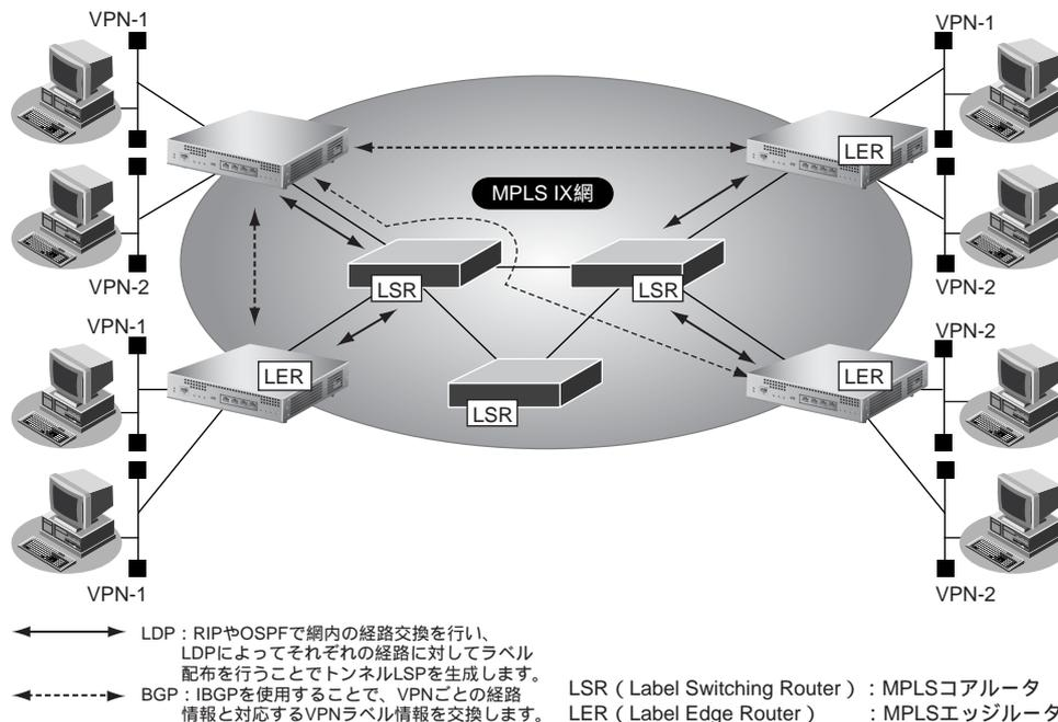
本装置では、ここで作成したLSPを仮想トンネルインタフェース (MPLS LSPトンネル) として利用することができます。MPLS網内では、OSPFやRIPなどのダイナミックルーティングプロトコルで経路情報が交換されます。MPLS制御ルータ (LSRとLER) は、LDPを用いて、それぞれの経路情報にラベルを対応付けることで、ラベルで転送可能なLSPを構築します。
