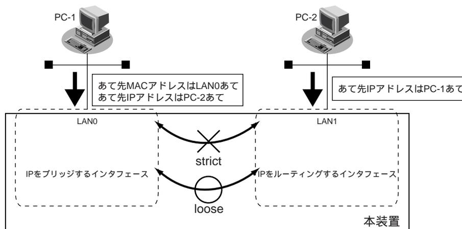
また、以下の図のように、ルータ機能を使用するインタフェースと、ブリッジ機能を使用するインタフェースを同時に動作させることができます。ブリッジが有効なインタフェース上で、IP もブリッジ対象としている場合は、転送ポリシーを選択することによって、ルータ機能を用いているインタフェースと IP をブリッジするインタフェースとの間の転送をブロックするかどうかを決めることができます。
