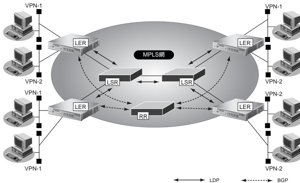
MPLS 網内では、OSPF や RIP などのダイナミックルーティングプロトコルで経路情報が交換されます。MPLS 制御ルータ (LSR と LER) は、LDP を用いて、それぞれの経路情報にラベルを対応付けることで、ラベルで転送可能な LSP を構築します。
