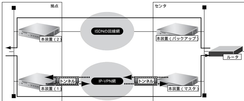
ISDN回線切断前は、本装置 (2) はセンタからの受信だけを受け持つこととなります。しかし、無通信監視の方向性機能を利用して送信だけを監視することによって、設定した時間になると回線が自動的に切断されます。
