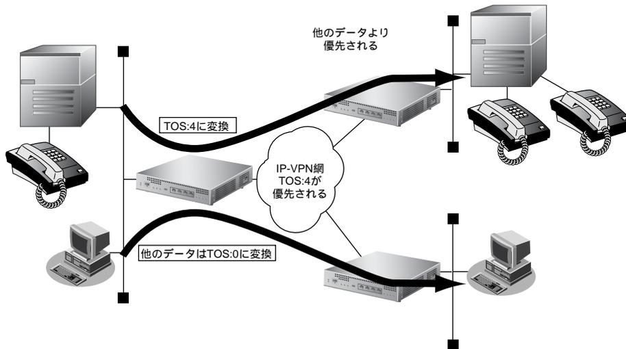
TOS 値書き換え機能は、IPv4[RFC791]で定義されている、IP パケットヘッダにある 8 ビットの Type Of Service (TOS) フィールドを制御することができます。一般的にはこの中の Precedence フィールドを TOS フィールドと言いますが、本装置では Precedence を含む 8 ビット全体を書き換えることができます。
