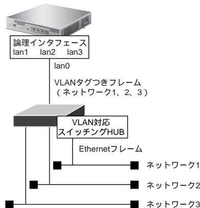
VLAN対応機器どうしてVLANインタフェース間の通信を行う場合は、Ethernetフレームの送信時にVLANタグをフレームに付加して送出します。VLANタグには、VLAN IDが格納されています。受信側ではVLANタグ中のVLAN IDを見て、フレームを受けとるインタフェースを決定します。
