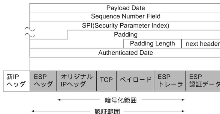
ESPはIPパケットを認証 (IPパケットの改ざんチェック) だけではなく、IPパケットを暗号化します。
