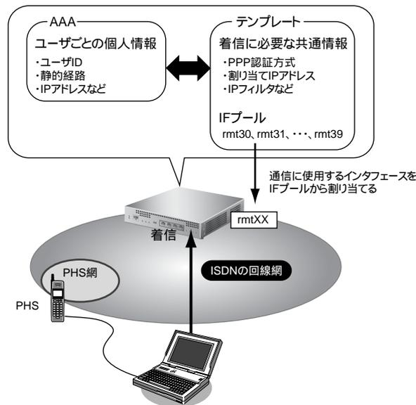
テンプレート着信時に使用するインタフェースは、テンプレート用に予約されたIFプールから、空いているインタフェースを自動的に検索して通信します。
