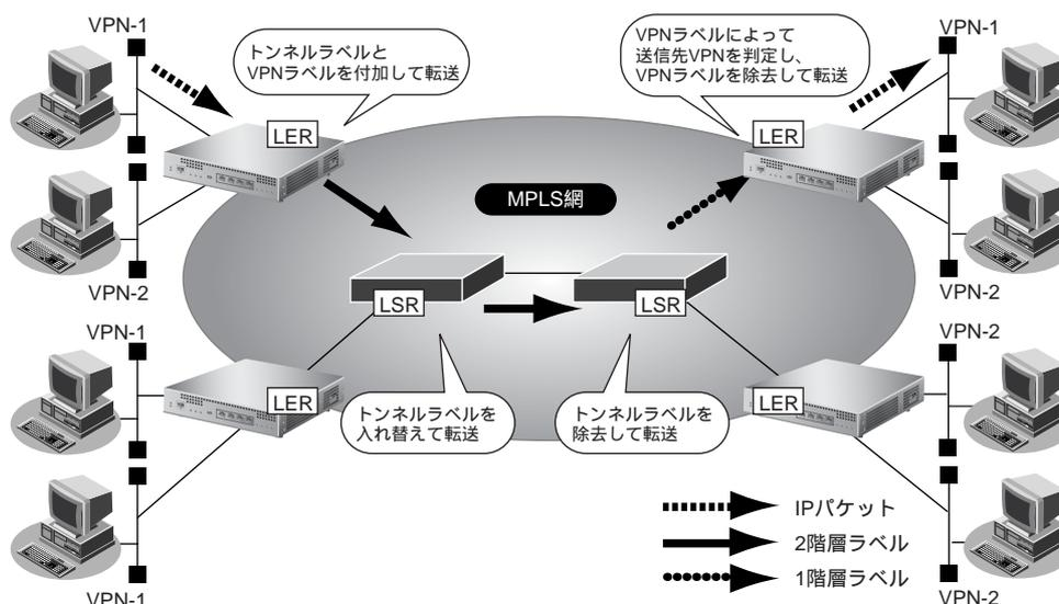
VPN サイトから送信されたパケットは、入口のLERで、あて先をVPN経路から検索して、VPNラベルを付加します。次に、MPLS網内をラベル転送するためのトンネルラベルを付加し、LSRへ転送します。MPLS網内ではトンネルラベルだけを参照して、トンネルラベルを入れ替え（スワップ）ながら、ラベル転送を行います。PHP（Penultimate Hop Popping）機能によって、出口の1つ手前のMPLS制御ルータでトンネルラベルを除去し、VPNラベル付きのパケットが出口のLERに到着します。出口のLERでは、VPNラベルによって出力先インタフェースが決定され、VPNラベルを削除したあと、VPNサイトへ転送します。
