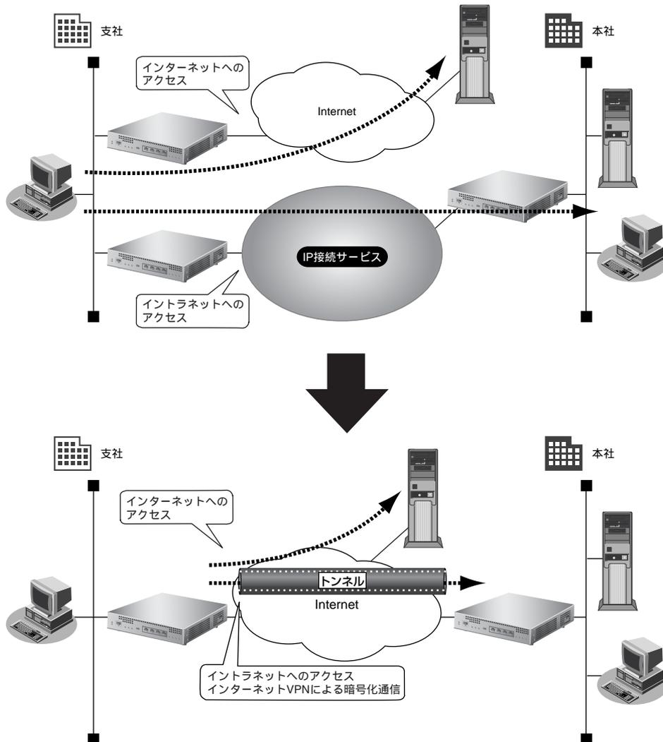
本装置ではVPNを実現するためにIPsecというプロトコルを使用します。
