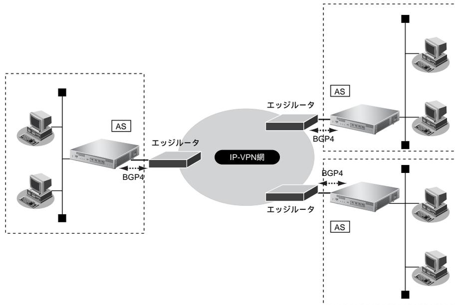
BGP4のセッションには、EBGP (External BGP) とIBGP (Internal BGP) の2種類があります。EBGPはAS間で使用するBGPセッションで、IBGPは同じAS内で使用するBGPセッションです。
