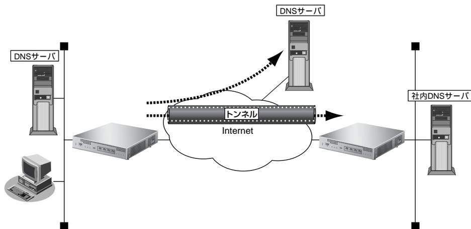
本装置が端末からDNSのQueryメッセージを受信した場合、DNS振り分けテーブル内に、問い合わせ先のドメイン名と一致するエントリが存在するかどうかをチェックします。一致するエントリが存在する場合は、その一致したエントリのDNSアドレスにメッセージを転送します。一致するエントリが存在しない場合は、デフォルトDNSアドレスにメッセージを転送します。
