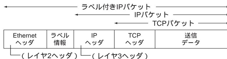
本装置では、MPLSのラベル配布プロトコルとしてLDP (Label Distribution Protocol) をサポートしています。LDPは、隣接LSRとLDPセッションを確立し、OSPFやRIPなどでやりとりされる経路情報を元にラベル生成を行い、メッセージ交換によりラベル配布を行うことでLSP (label Switching Path : トンネルラベルスイッチングパス) を構築するプロトコルです。
