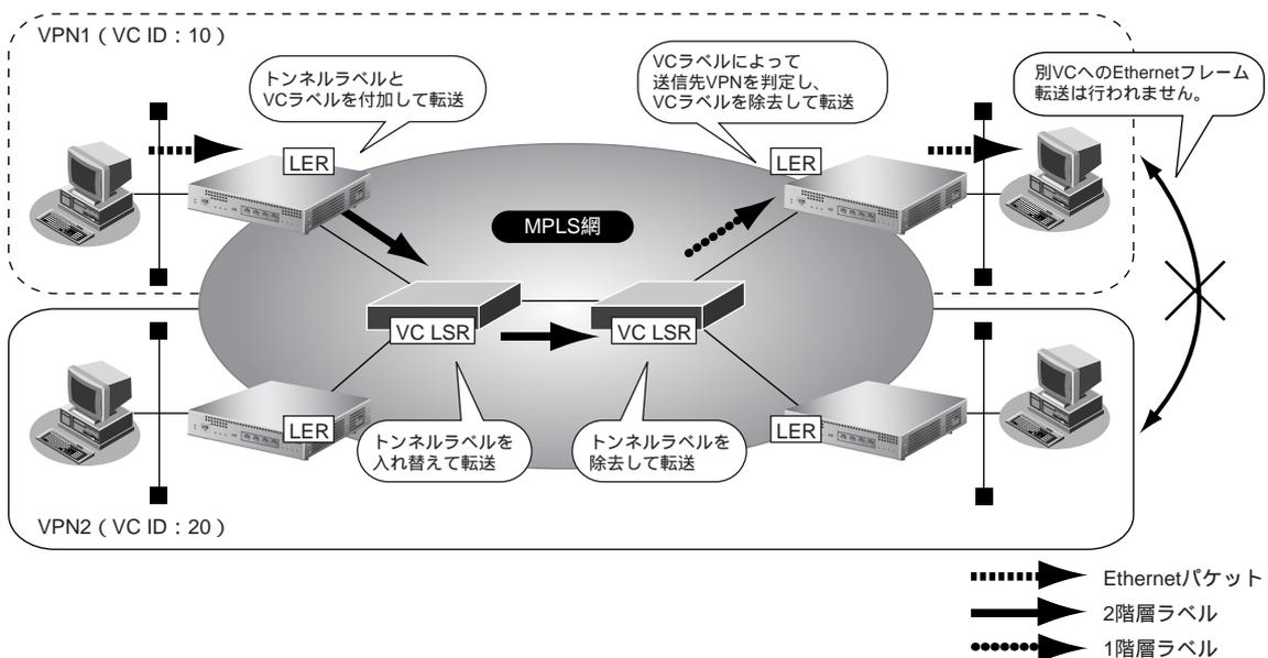
VPN サイトから送信された Ethernet フレームは、入口の LER で、あて先を VC ラベルを付加します。次に、MPLS 網内をラベル転送するためのトンネルラベルを付加し、VC LSR へ転送します。MPLS 網内ではトンネルラベルだけを参照して、トンネルラベルを入れ替え（スワップ）ながら、ラベル転送を行います。PHP（Penultimate Hop Popping）機能によって、出口の1つ手前の MPLS 制御ルータでトンネルラベルを除去し、VC ラベル付きの Ethernet フレームが出口の LER に到着します。出口の LER では、LAN インタフェースに設定された VC ID とあて先のアドレスで VC インタフェースが決定され、VC ラベルを削除したあと、VPN サイトへ転送します。
