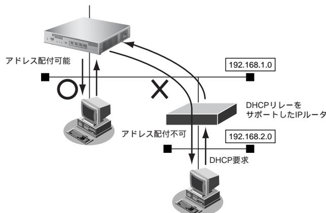
以下に、本装置の簡易 DHCP サーバ機能の設定内容を示します。
