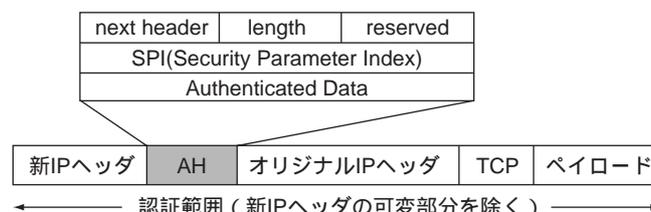
AH は IP パケットを認証するために IP ヘッダに拡張されるものです。元々ある IP パケットの前に IPsec ゲートウェイのアドレスと上記の構成からなる AH ヘッダを挿入します。
