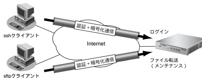
本装置の電源投入時およびリセット時に本装置の SSH ホスト認証鍵が生成されます。生成時間は、数十秒から数分です。SSH ホスト認証鍵生成開始時と完了時にシスログが出力され、生成完了した時点から本装置に SSH 接続することができます。
